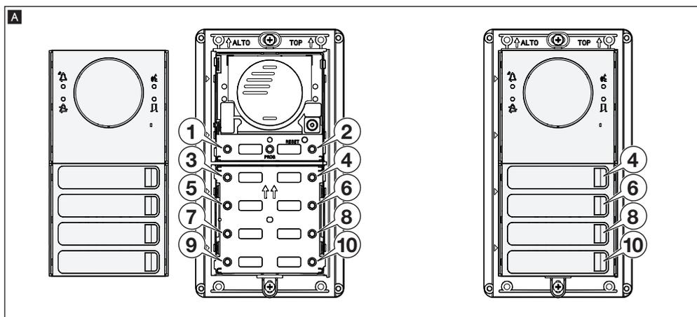
Каждая группа может быть закреплена за клавишей вызова (см. главу 3 «Закрепление группы абонентов за клавишей вызова вызывной панели»). Нумерация клавиш следует логике, показанной на рисунке **A**. Согласно этой логике, клавиша 1 закреплена за группой 1, клавиша 2 — за группой 2 и т.д.; телефонным номерам, входящим в одну группу, присваивается порядок вызова, используемый для переадресации в том случае, когда абонент не отвечает **B**.
